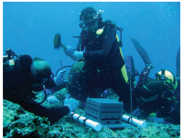
8. 人造暗礁监控结构 (Artificial Reef Monitoring Structures) 是由 PVC 制成的小盒子，带有许多细小的孔洞，可供诸如蟹类等无脊椎动物和软体动物栖息。它们设计用于模仿暗礁环境，在一至两年之后，那些盒子会从暗礁上拆除，研究人员将研究什么样的生物体会定居在这些盒子的里面和上面。来源：Andy Collins, 美国国家海洋和大气管理局 (National Oceanic and Atmospheric Administration)
